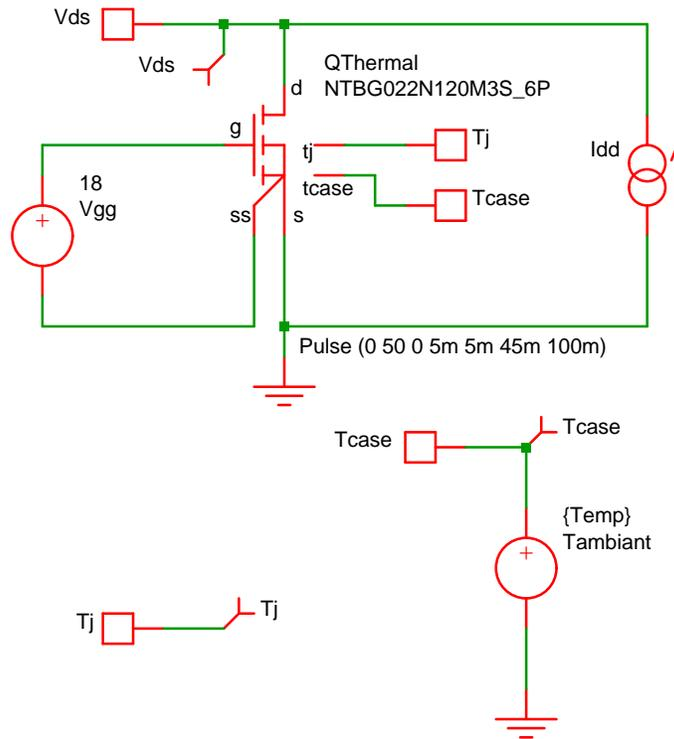
**Figure 19. Electro-Thermal Simple Approach**
